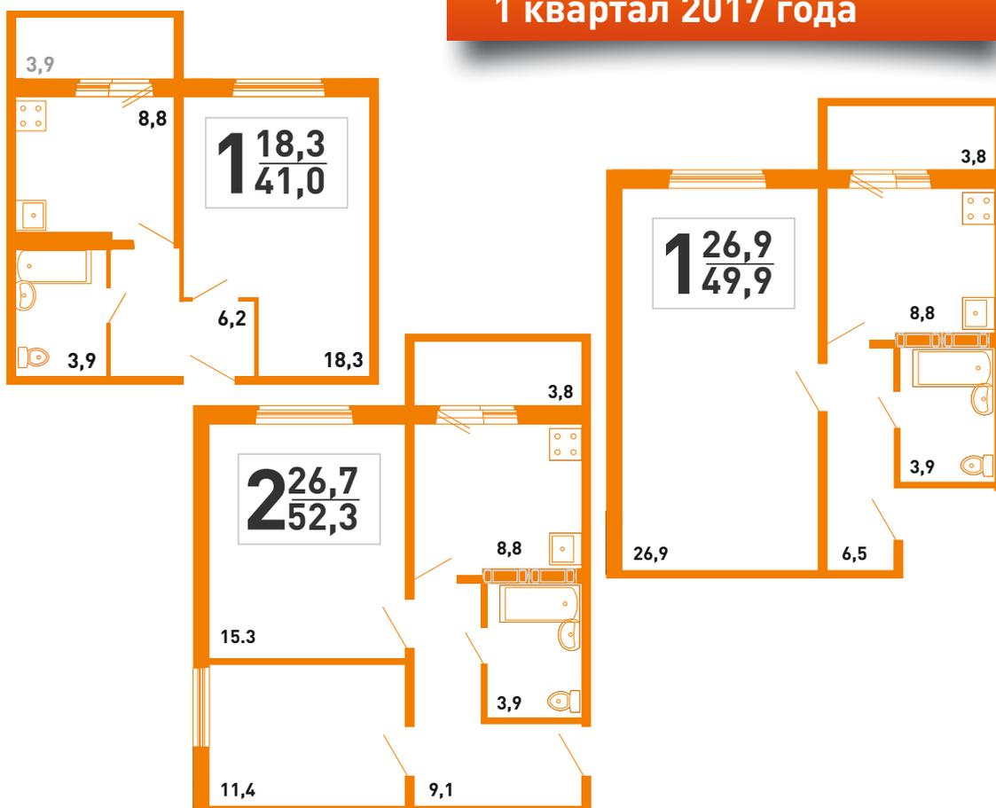
Строение №64 — это четырехподъездный дом переменной этажности: в 1 и 4 секции по 10 этажей, во 2 и 3 — 12. Материал наружных стен — железобетон. Высота жилых этажей — 2,7 метра. Отделка квартир «под ключ», с 4 этажа — панорамное остекление.
