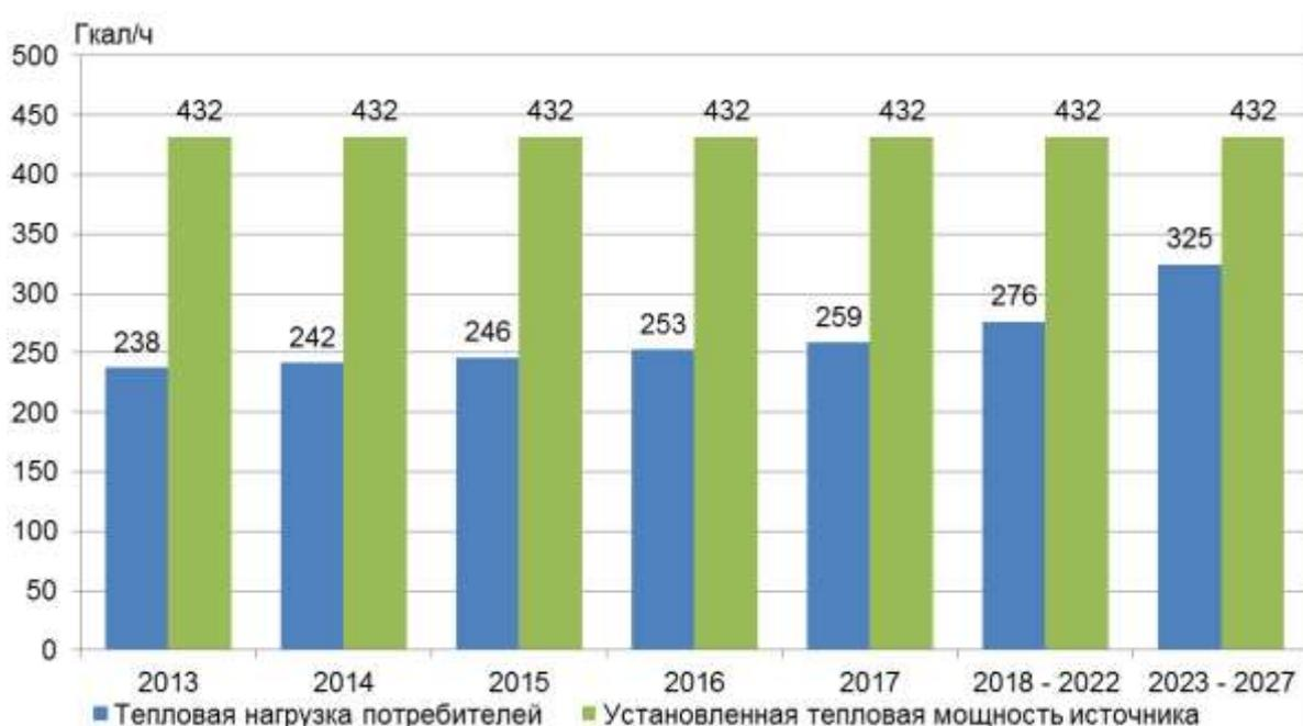
Рис. 2.6. Соотношение присоединённой тепловой нагрузки потребителей и установленной тепловой мощности котельной «Арбеково»
