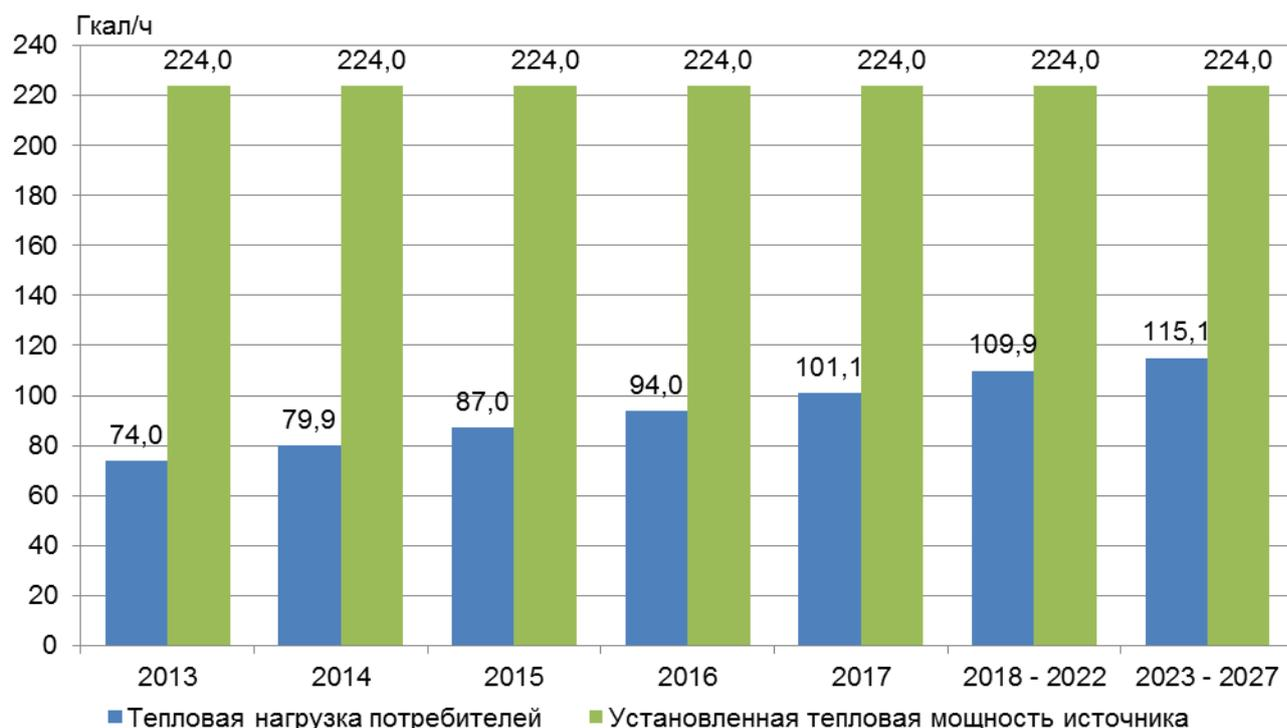
Рис. 2.3. Соотношение присоединённой тепловой нагрузки потребителей и установленной тепловой мощности котельной ОАО «ЭСР»
