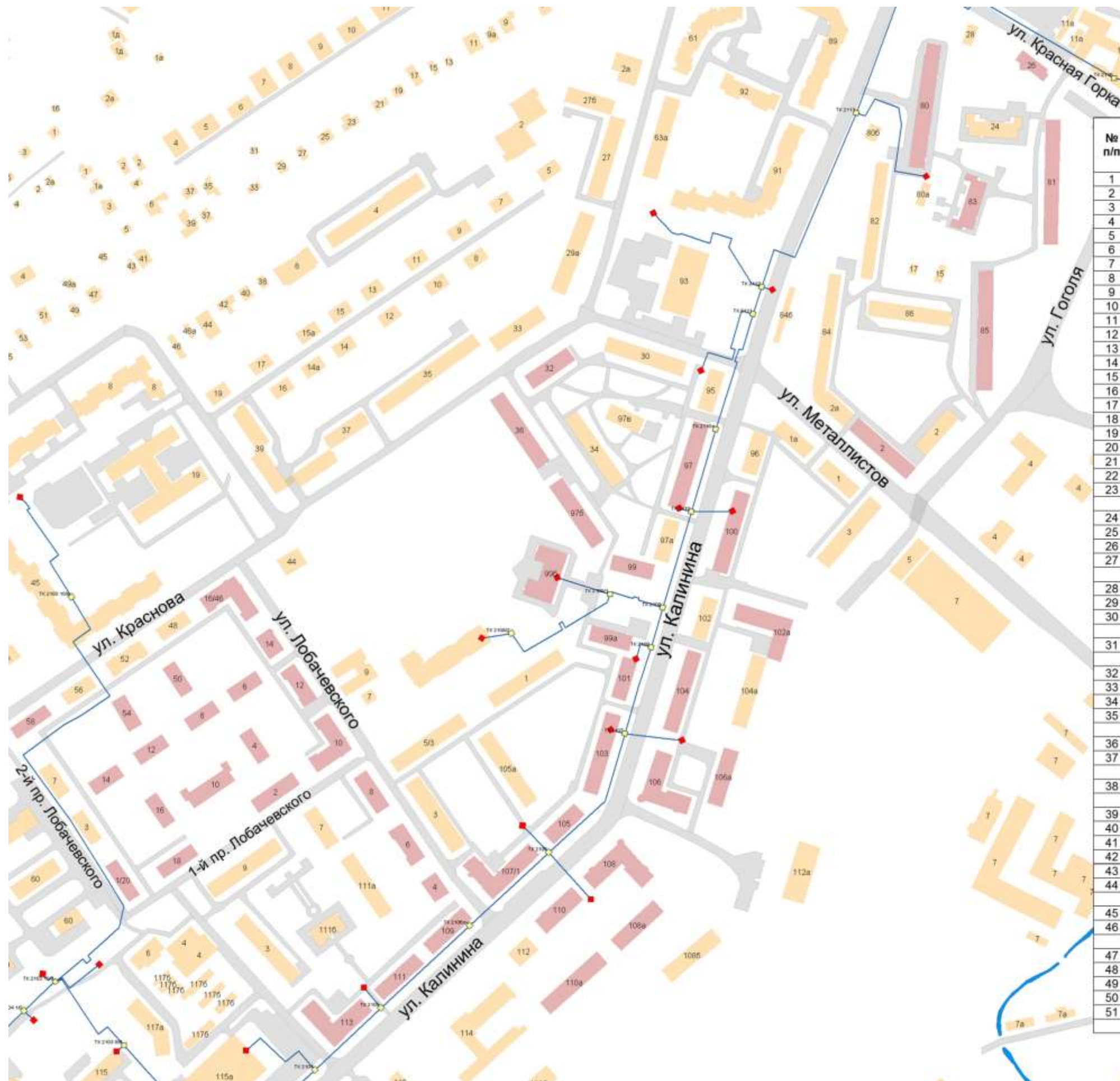
Рис. 1.5. Схема расположения зданий с открытой схемой горячего водоснабжения с указанием тепловой нагрузки потребителей
