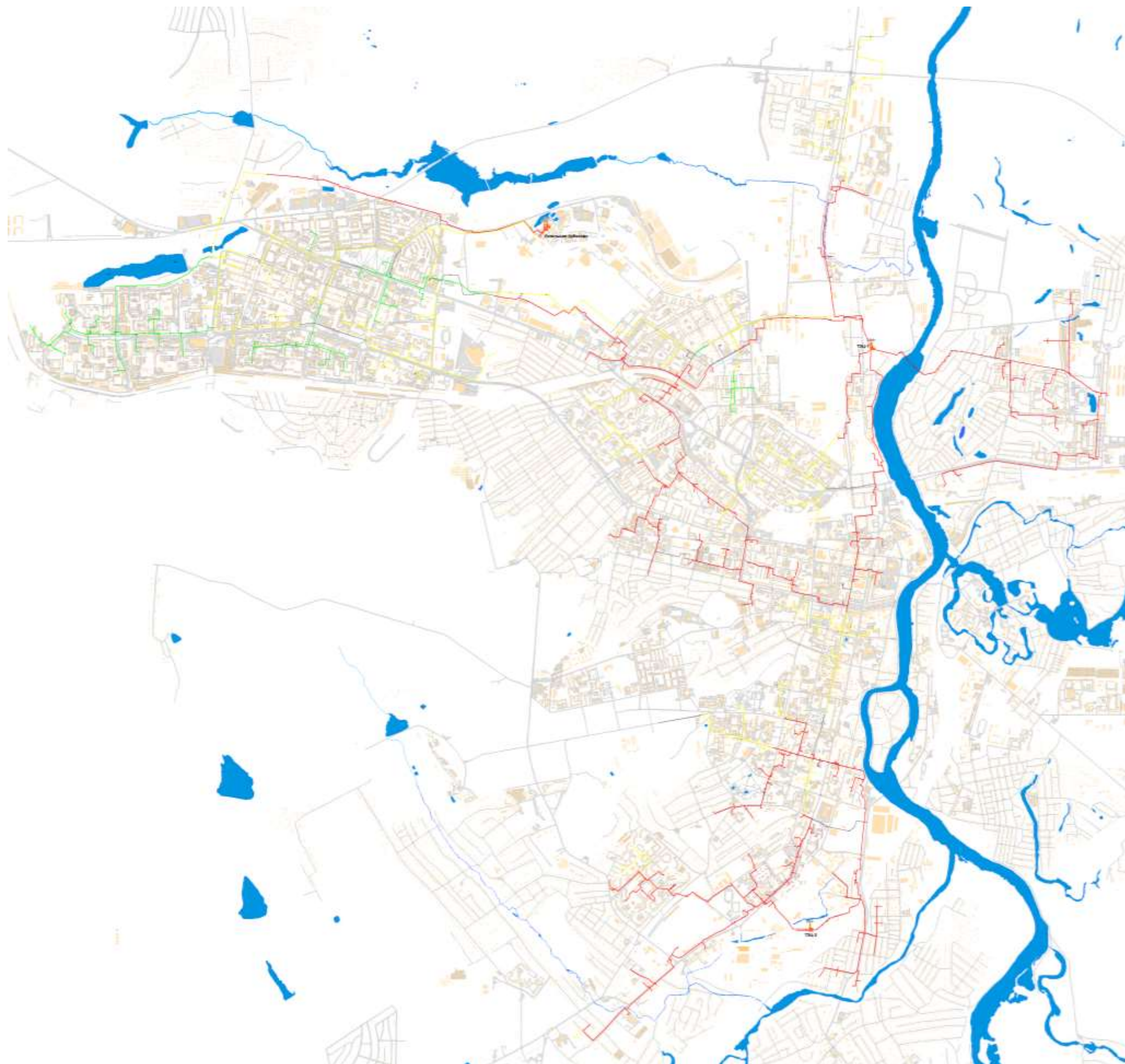
Рис. 2.1. Расчетный располагаемый напор в тепловых сетях г. Пензы по состоянию на конец 2017 года с учетом перспективных тепловых нагрузок (красные линии - >60 м.в.ст, жёлтые - >30 м.в.ст, зелёные - > 15м.в.ст)
