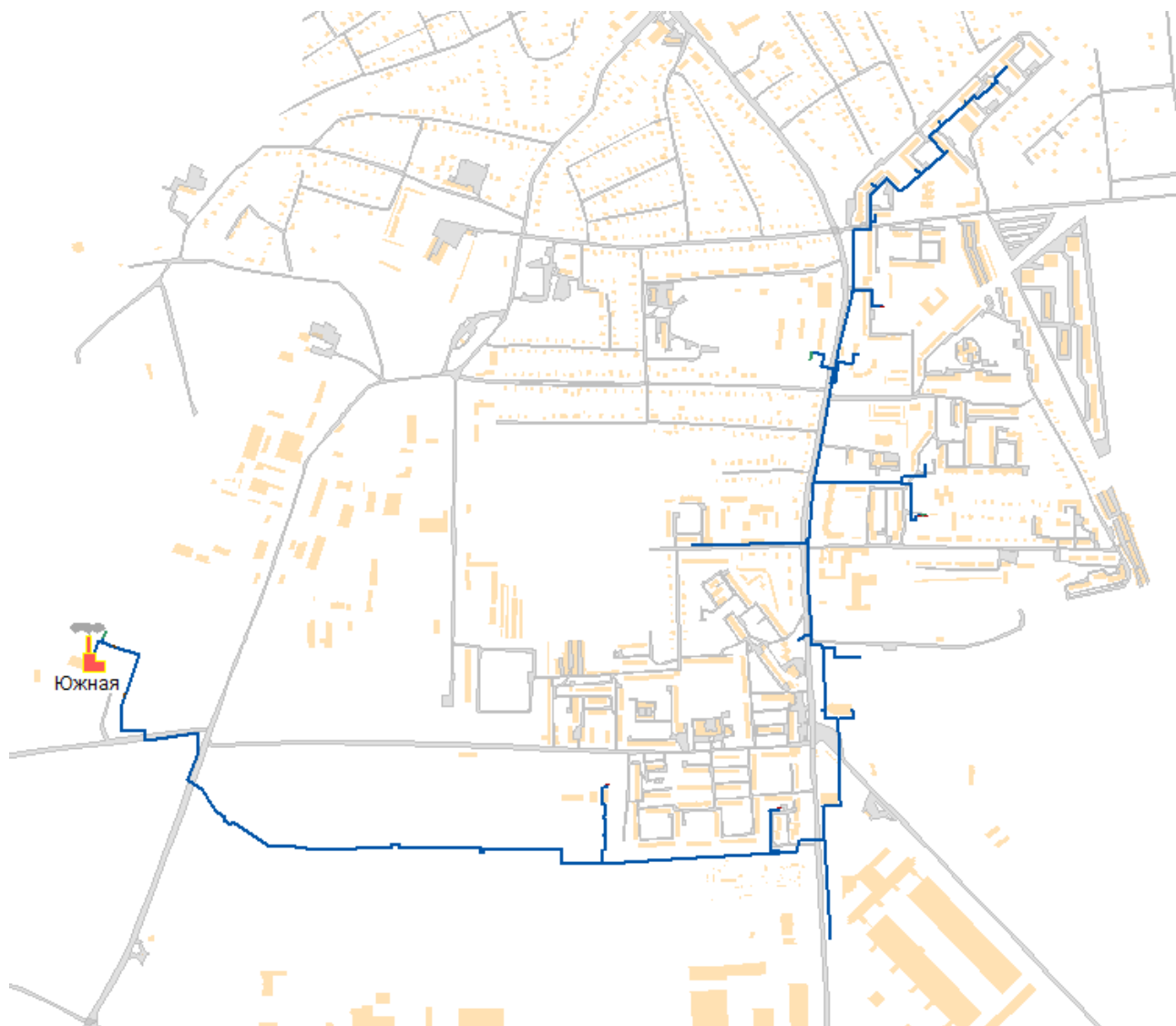
Рис. 2.5. Схема теплоснабжения от котельной «Южная»
